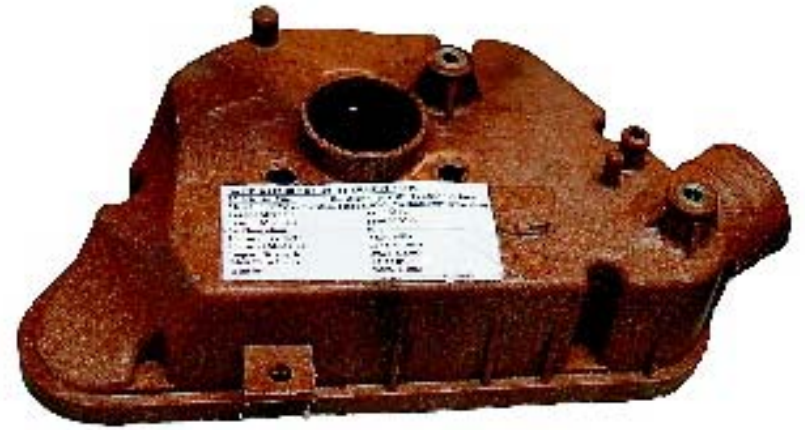
Spritzgussteil aus Bambus-Polymer-Composite (BPC)
